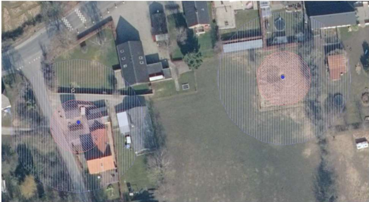
Figur 1 Placering af vandværk samt boringer med 10 m fredningsbælte (inderste røde cirkel) og 25 m dyrkningsforbud (yderste lyseblå cirkel). Matrikelafgrænsning er vist med gul streg.
